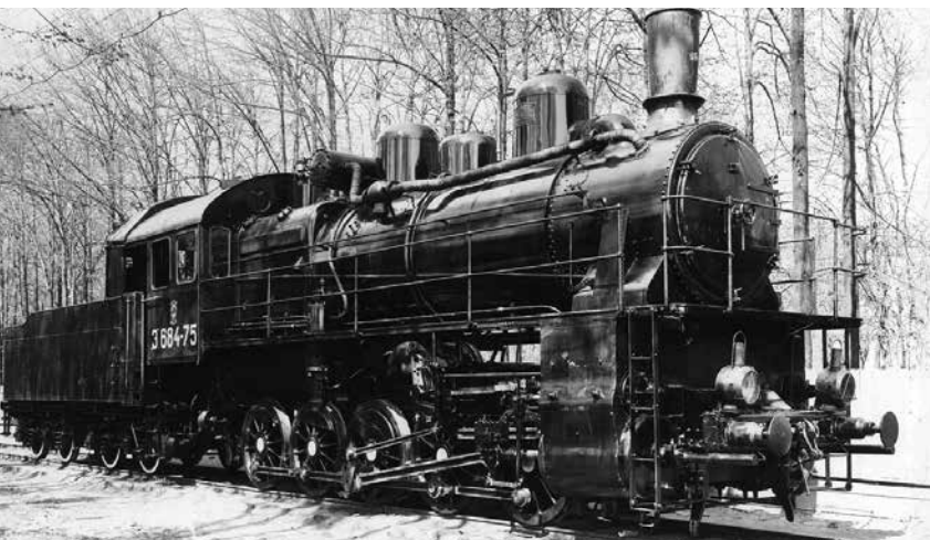
Güterzuglokomotive der Baureihe ER, von der in den Jahren 1926/31 insgesamt 2.325 Stück in verschiedenen Fabriken, darunter in Kolomna hergestellt wurden. 10
